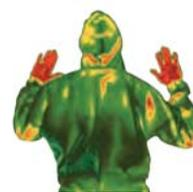
Комбинезон KLEENGUARD\* A45 Температура ниже и распределена более равномерно.
